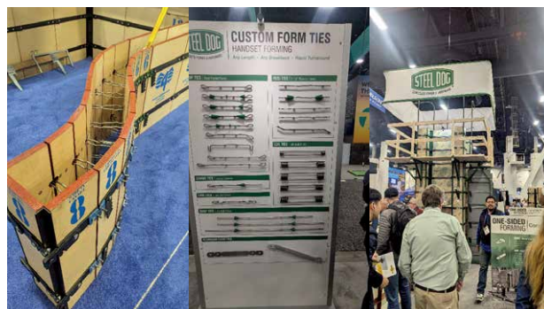
曲面用の型枠（左） スパースーの見本（中） 木製の足場（右）
